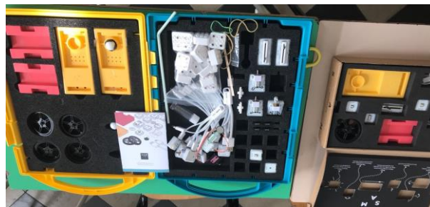
2 - I blocchetti elettronici di SAM Labs , permettono di creare ed animare robot con la programmazione a flusso dell'app dedicata
